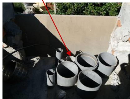
Tratto di tubazione rotto e leggermente disassato.(BAC)(BAJ)
